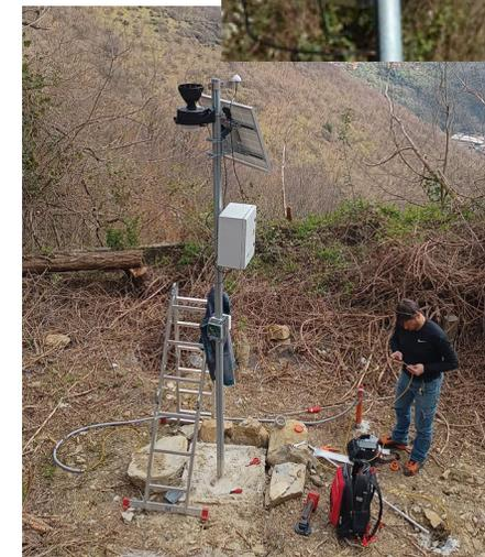
Monitoraggio con inclinometri, sensori di umidità e pluviometro
