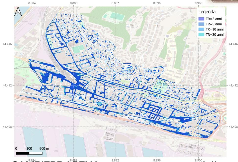
SAMPIERDARENA: mappa della pericolosità/scenari di allagamento per piogge caratterizzate da diversi tempi di ritorno elaborato tramite modellazione idraulica, nell'ipotesi di caditoie ostruite.
